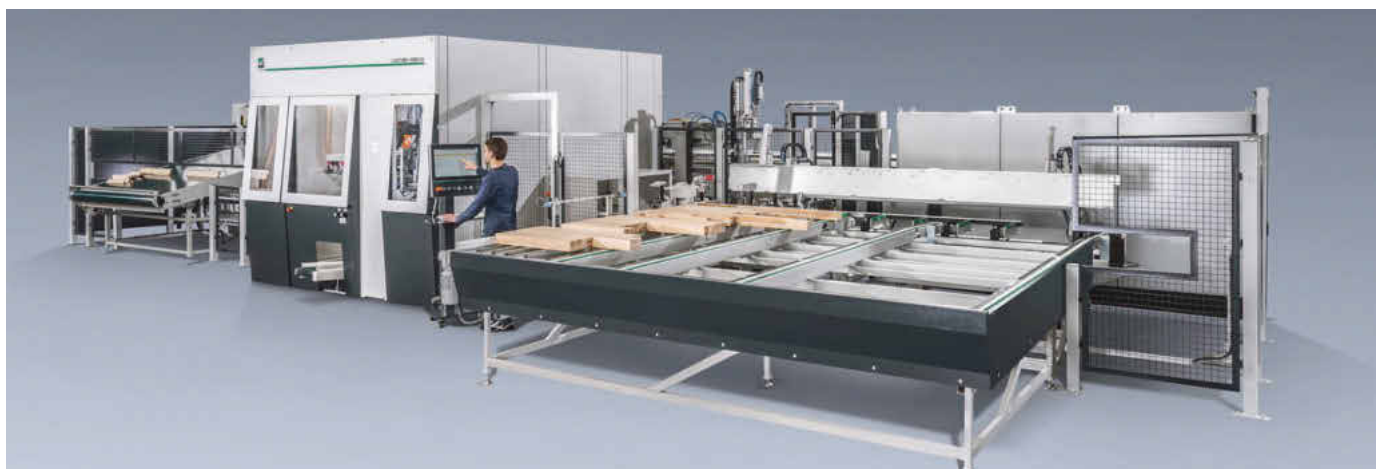
Ein neuer Quer-Quer-Längs-Ablauf steigert den Durchsatz an der Conturex Vario XS
