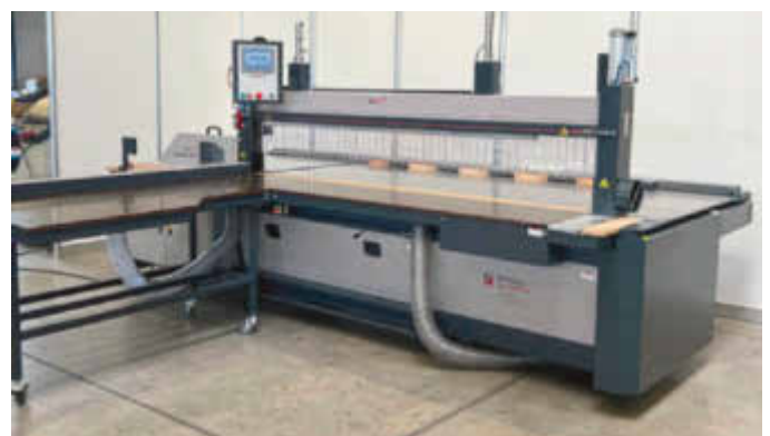
Längsschnittsägen konstruiert Stoll schon seit 20 Jahren: Auch das Modell Multicut folgt dem Grundkonzept
