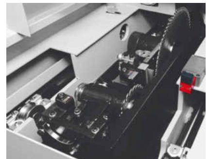
Die Schnitthöhe wird manuell, pneumatisch oder elektromotorisch eingestellt
