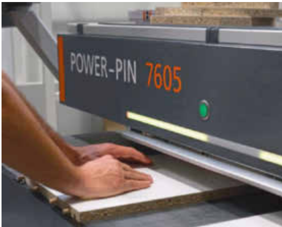
Nesting und dann? Automatisches Dübelbohren und -eintreiben auf der Power-Pin 7605 Dynamic
