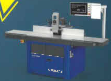
Fräsen mit der profil 45 M x-motion inkl. Frässpindel-Schnellwechselsystem
